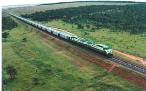
Trem da Ferronorte no trecho com duas locomotivas GE "Dash 9" e vagões hopper de alumínio (acervo ANTF)
